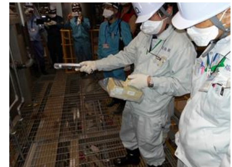
損傷箇所付近の空間線量率測定
